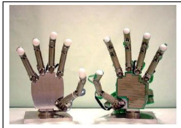
Figure III.1 : La Gifu Hand III nue (modèle de gauche) et couverte par son réseau de capteurs de contact (modèle de droite) [2].
